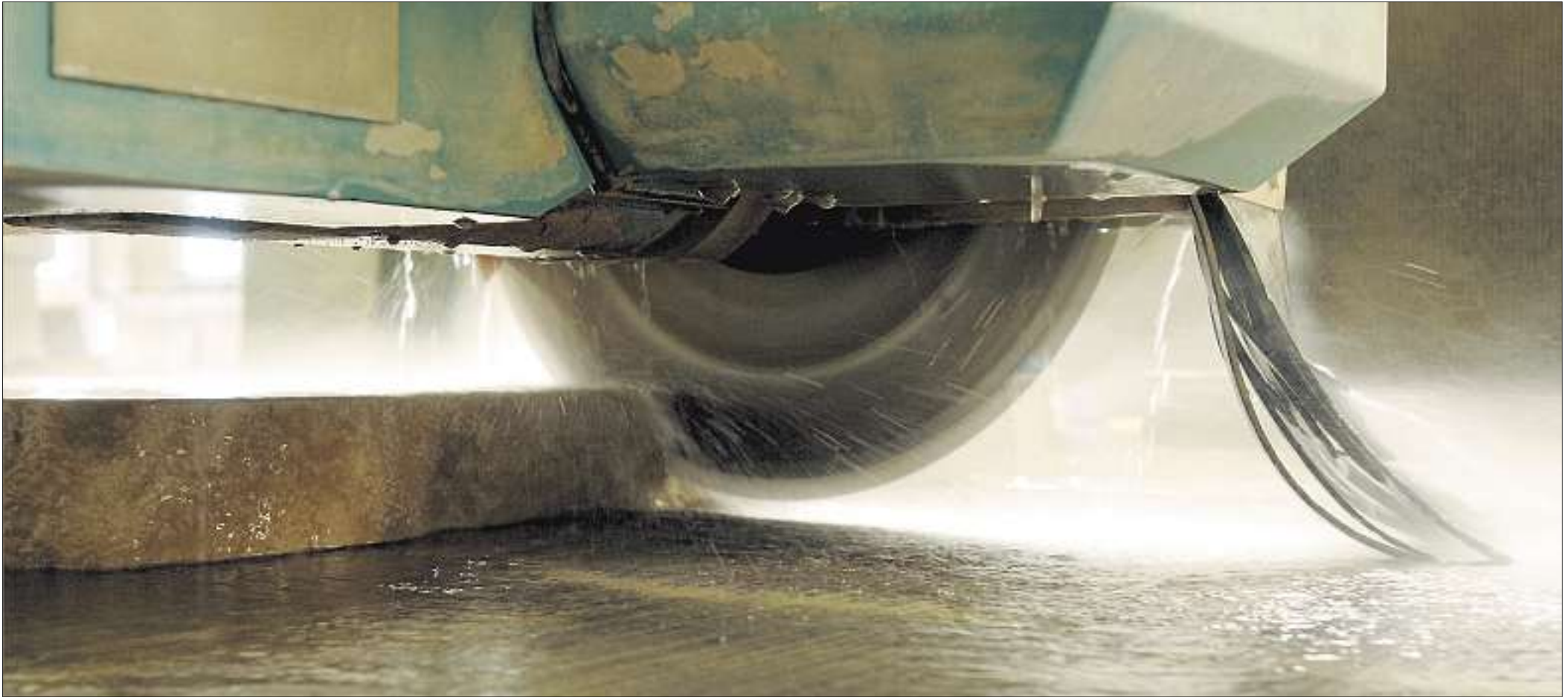
Wie nimmersatte Raupen fräsen sich die Schneidescheiben durch den harten Stein
